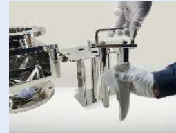
⑤一重管の外側もごみを取り除く
