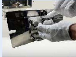
③ロックを持ち上げ二重管からマグネットを引き抜く
